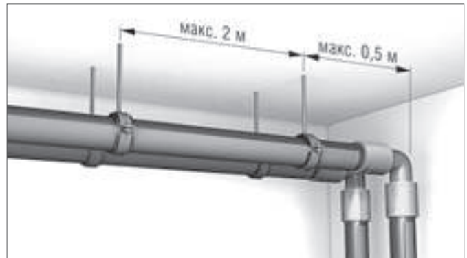
Рис. 6-3 Максимальное расстояние между хомутами
