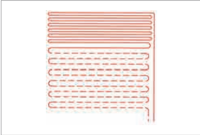
Рис. 16-14 Укладка змеевиком с более плотной укладкой в граничной зоне
